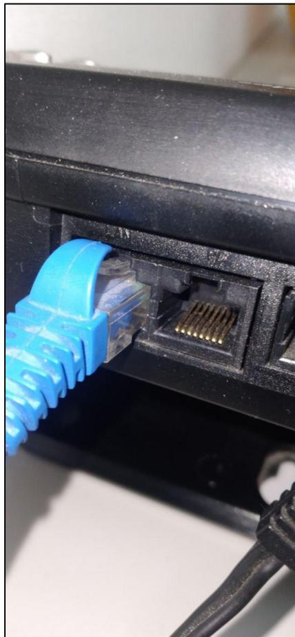
**Figura 2 - Cabo de rede conectado corretamente à porta LAN**
